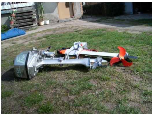
Der Propeller eines Honda 4,5 PS Verbrennungsmotors im Vergleich zu dem eines Torqeedo Cruise 2.0
